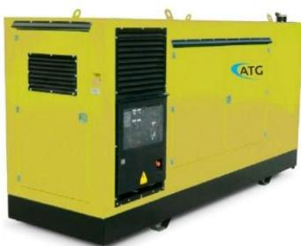
エンジン/交流機 柔軟性のあるディスク連結を通じ結合した一体鋳造型ユニット、溶接による鋼鉄基礎枠組への設置、土台部位振動対策を完備。15/10 鋼板ドア付き防音筐体、防音素材、内部サイレンサー、鋼鉄製の取っ手と蝶番、鍵付きの外部燃料タンクキャップ、吊り上げフック、RAL 1004 (明るい黄色) のパウダー塗装。
